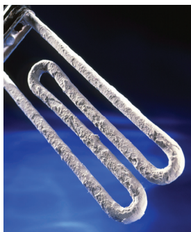
kamień kotłowy osadzony na grzałce pralki
